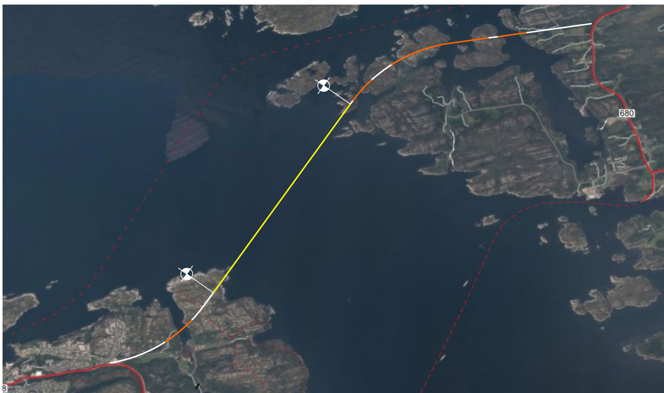
Figur 1: Krysningstrasé med linjeføring fordelt på hengebru (gult), bru (oransje) og veg (hvitt).
