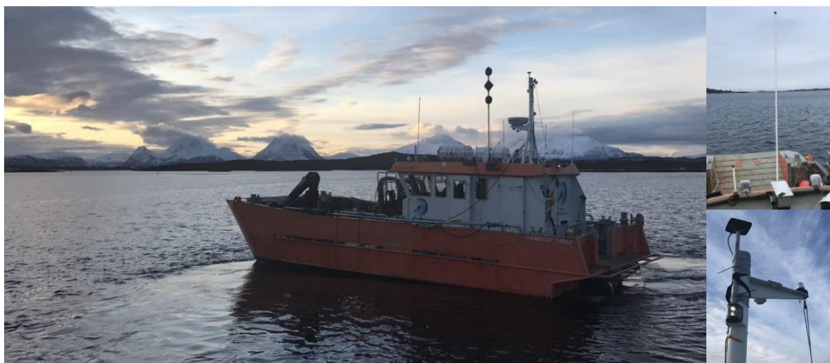
Figur 3: Triton, katamaranen som ble brukt i undersøkelsesprogrammet. Antenner for navigasjon ble plassert på toppen av båten (se innfelte bilder).
